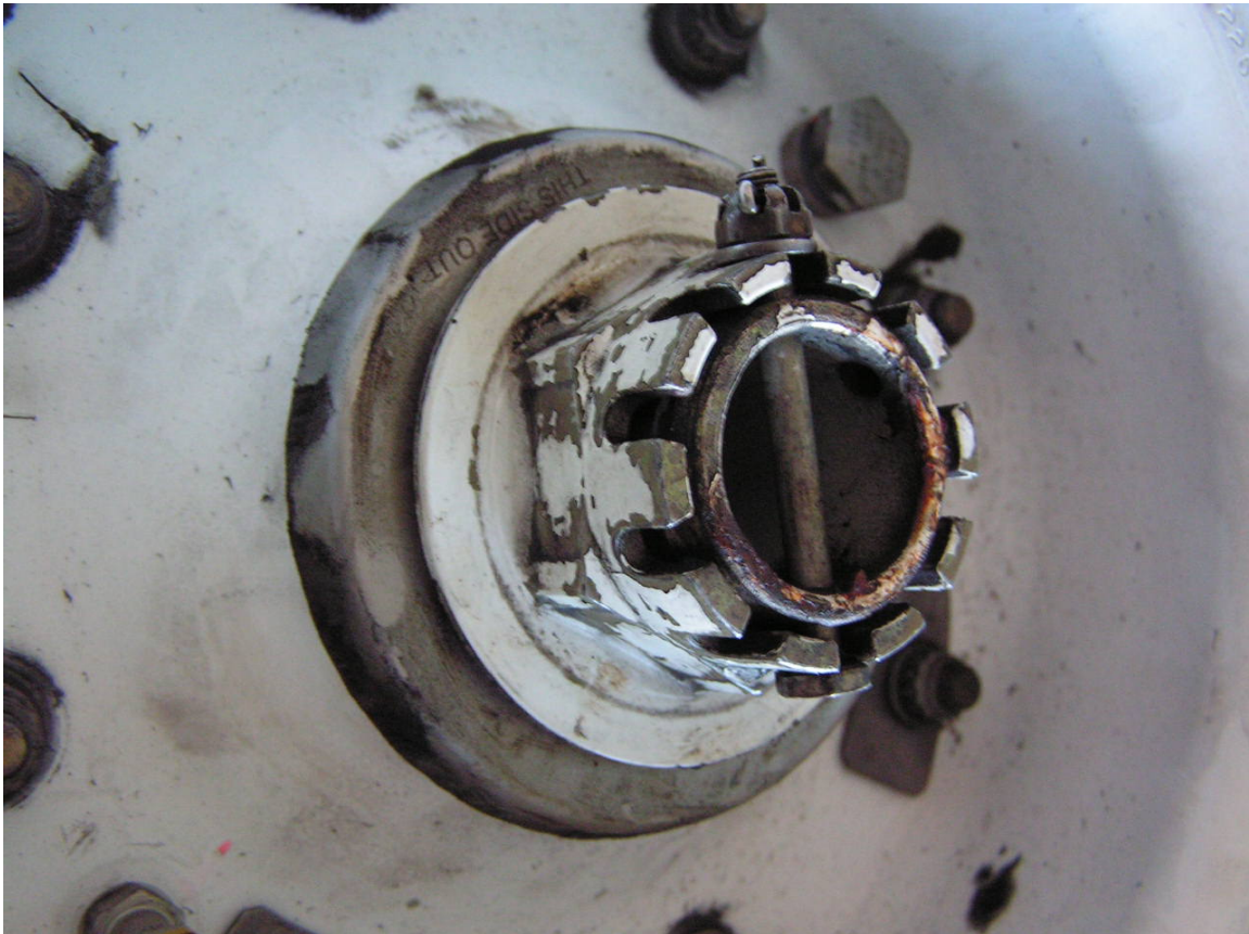
Abb. 2: Achse mit Kronenmutter und Sicherungsschraube
