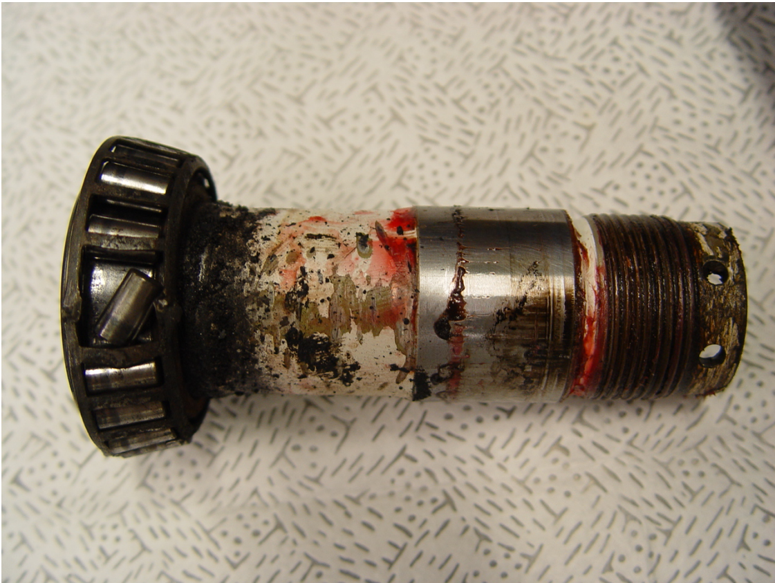
Abb. 3: Achsstummel mit zerstörtem Kegelrollenlager
